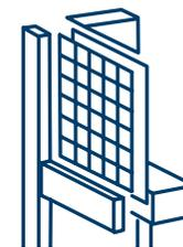
Solution constructive de l'enveloppe du bâtiment où la lame d'air est ouverte et permet la circulation de l'air à l'intérieur par effet cheminée. Elle permet la régulation thermique du bâtiment en été comme en hiver et évite les problèmes de condensation. Elle est composée des cinq éléments suivants :
